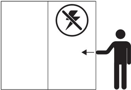
Im Fall einer fehlenden Stromversorgung kann man die Türen von Hand bewegen, jedoch ist aufgrund der Reibung und des Widerstands des elektromechanischen Systems ein erhöhter Kraftaufwand notwendig.
