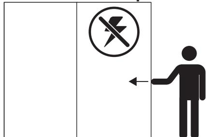
En cas de panne de courant, il est possible de déplacer les portes manuellement. Toutefois, il est prévu d'utiliser une force supérieure à la norme en raison du frottement et de la résistance du système électromécanique.
