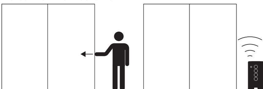
Une fois terminée la configuration des courses et de la télécommande, le système est opérationnel. Il est possible de contrôler le mouvement de chaque porte au moyen d'une impulsion manuelle sur la porte dans le sens de l'ouverture ou au moyen de la télécommande. Le contrôle du mouvement à l'aide de la télécommande ou par impulsion manuelle est
