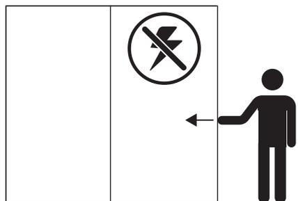
Si falla la corriente eléctrica, es posible mover de forma manual todas las puertas, no obstante, prevea el uso de una fuerza superior a la normal debido a las fricciones y a las resistencias del sistema electromecánico.
