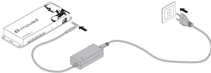
Una vez verificado que la conexión de los motores a la unidad de control es correcta y de haber puesto las puertas en posición de cierre, es posible alimentar la unidad de control con el alimentador suministrado.
