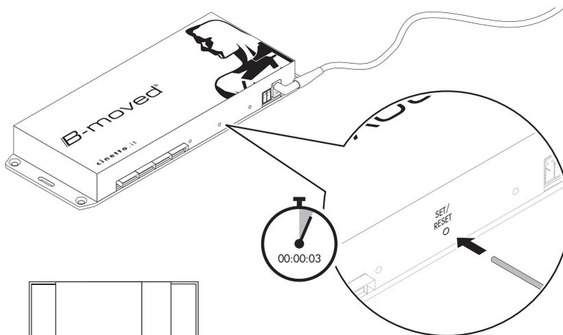
Die in Punkt 2.3 beschriebene Funktion zur automatischen Erkennung der Türenschafter durch Drücken und Halten (3 Sekunden) der Taste "SET / RESET" an der Steuerung starten. Ab diesem Punkt werden sich alle Türen, eine nach der Anderen, ab der ersten linken Tür des Schrankes, mit reduzierter Geschwindigkeit zu den entsprechenden Endschaftern bewegen.
