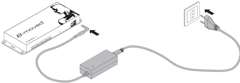
Nach der Kontrolle des korrekten Anschlusses der Motoren an die Steuerungseinheit und dem Bewegen der Türen in die Schließstellung kann die Steuerungseinheit über den mitgelieferten Trafo mit Strom versorgt werden.
