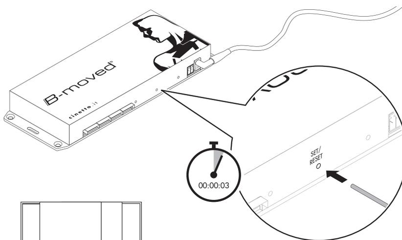
Démarrer la fonction pour la détection automatique des fins de course des portes décrite au point 2.3 en appuyant (3 secondes) sur le bouton "SET/RESET" situé sur l'unité de commande. À ce point, toutes les portes mais une porte à la fois et en commençant par la première porte à gauche de l'armoire, commenceront à se déplacer à vitesse réduite vers les interrupteurs de fin de course respectifs.
