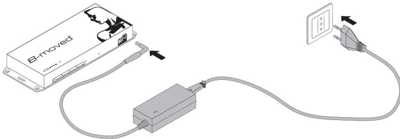
Après avoir vérifié le bon raccordement des moteurs à l'unité de commande et avoir mis les portes en position de fermeture, l'unité de commande peut être fournie avec l'alimentation fournie.
