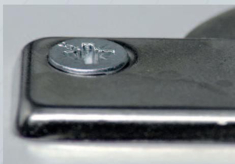
*La testa brevettata alloggia perfettamente nei fori dei profili. Grazie alle nervature autosvasanti brevettate con alette non sporgenti la vite appoggia a filo sulla ferramenta. La superficie del profilo metallico non viene danneggiata durante l'avvitamento.*
