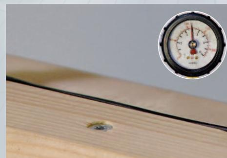
*Nel montaggio di componenti di elevato spessore, il fissaggio garantito dal filetto assicura una portata sensibilmente maggiore. Ciò consente di ridurre i punti di fissaggio e/o garantisce una maggiore sicurezza.*
